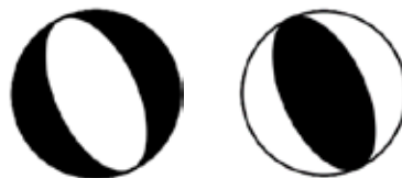
Slika 8. Žarišni mehanizmi za normalni i reversni rasjed nagiba 45^\circ .
