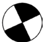
Slika 7. Žarišni mehanizam za rasjede s pomakom po pružanju.
