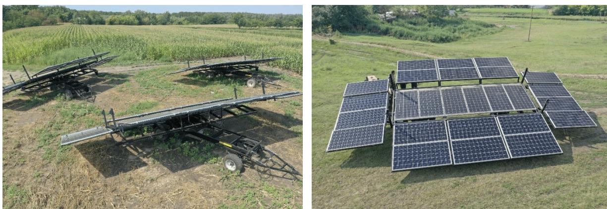
Slika 5-6 – Primjeri samostalnih (mobilnih) solarnih sustava
