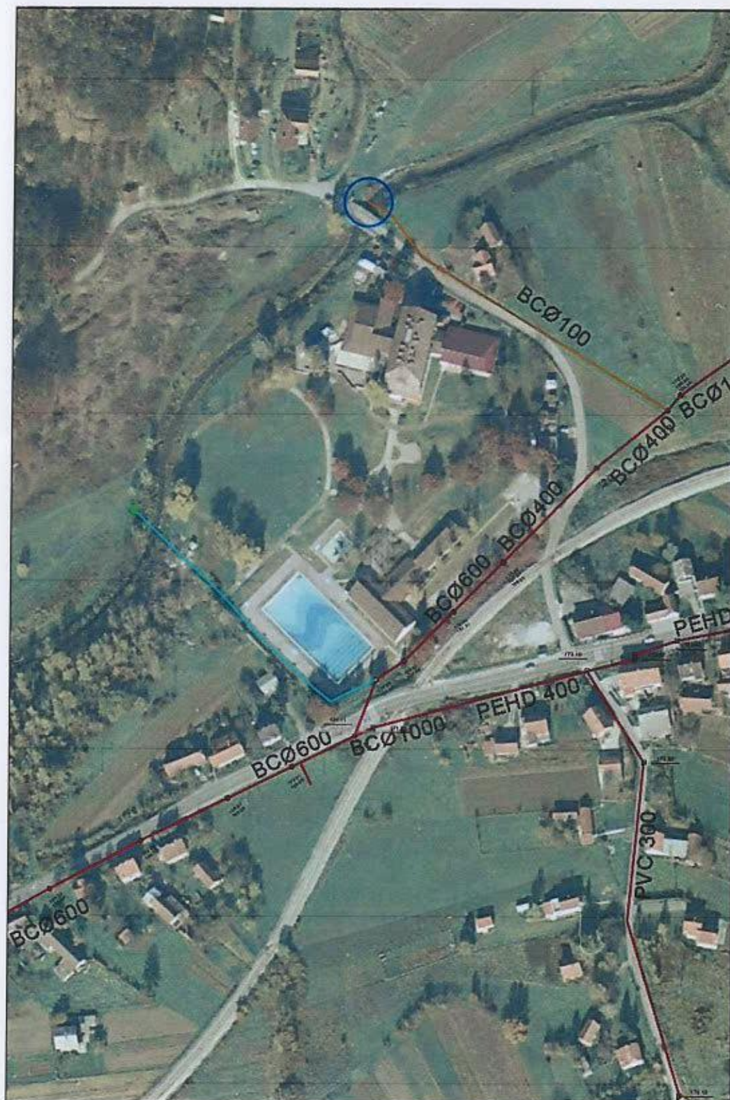
Situacija postojećeg sustava javne odvodnje
