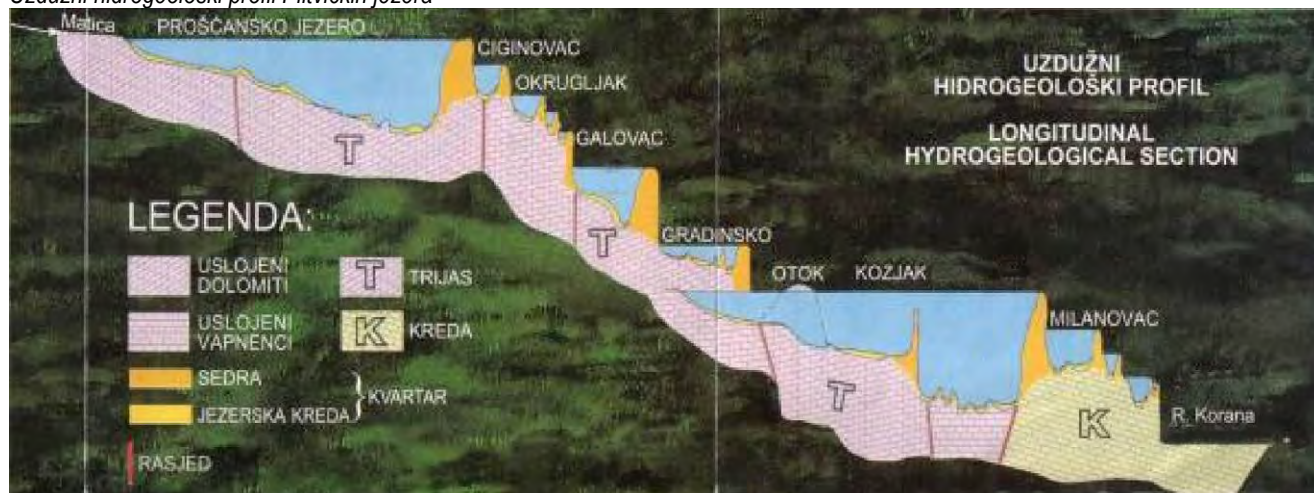
Uzdužni hidrogeološki profil Plitvičkih jezera
